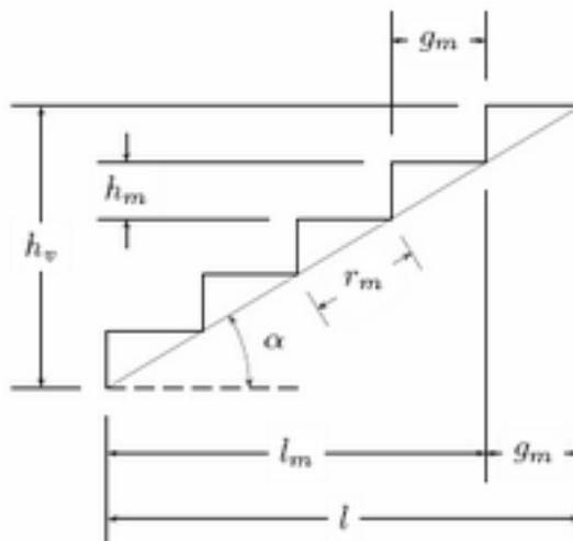
Pour avoir un escalier confortable, on cherche à réaliser à peu près la condition (1):  $g_m + 2h_m = 0,64$  exprimé en mètres. On souhaite réaliser  $n$  marches.
